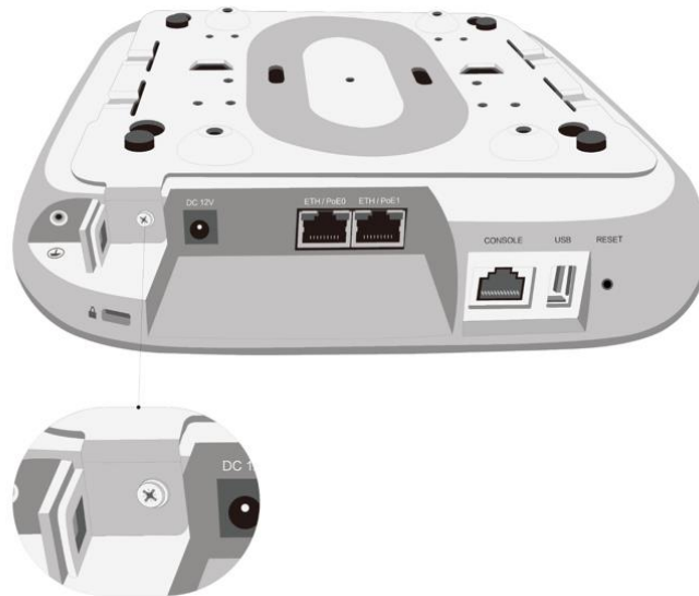
图 3-8 吸顶支架安装示意图
