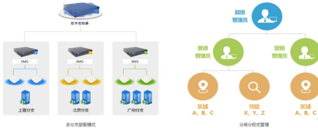
分支路由管理。信锐 XMG 多业务网关具备策略路由功能。例如，在分支出口部署一台 XMG-5100，对于购买了 3 条 ADSL 拨号宽带的分支，可根据源 IP 和目的 IP 来控制流量分发。
