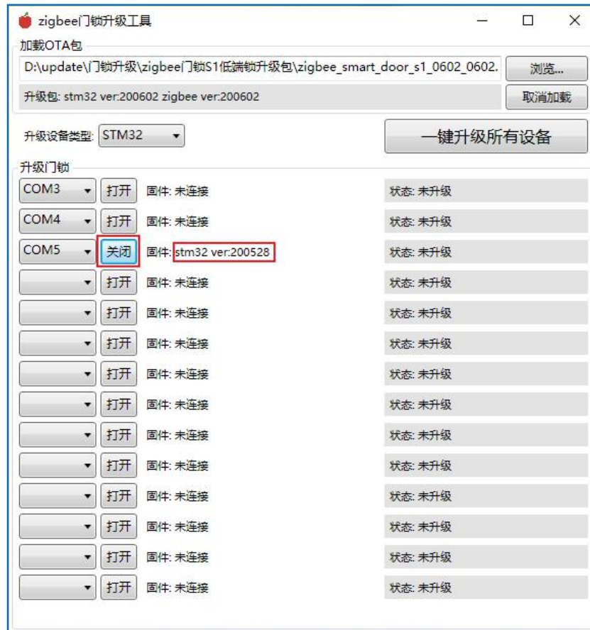
5-6 Zigbee 门锁升级工具检测版本
