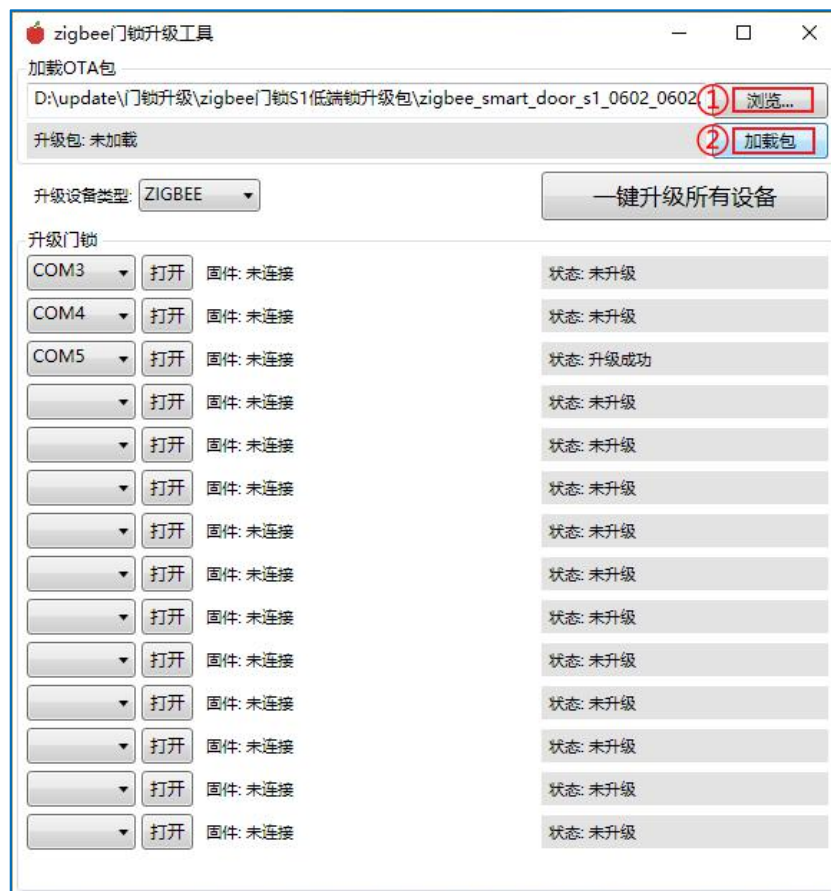
图 5-5 Zigbee 门锁升级工具加载固件包
