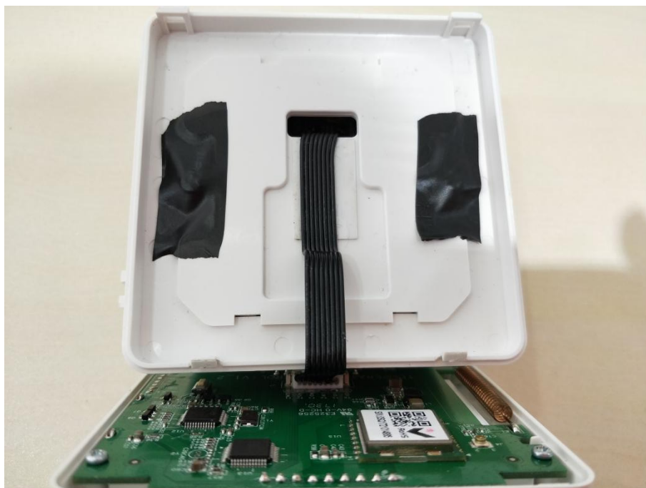
螺丝帽处打上电胶布，防止螺丝意外松动脱落接触到控制板，造成漏电短路
