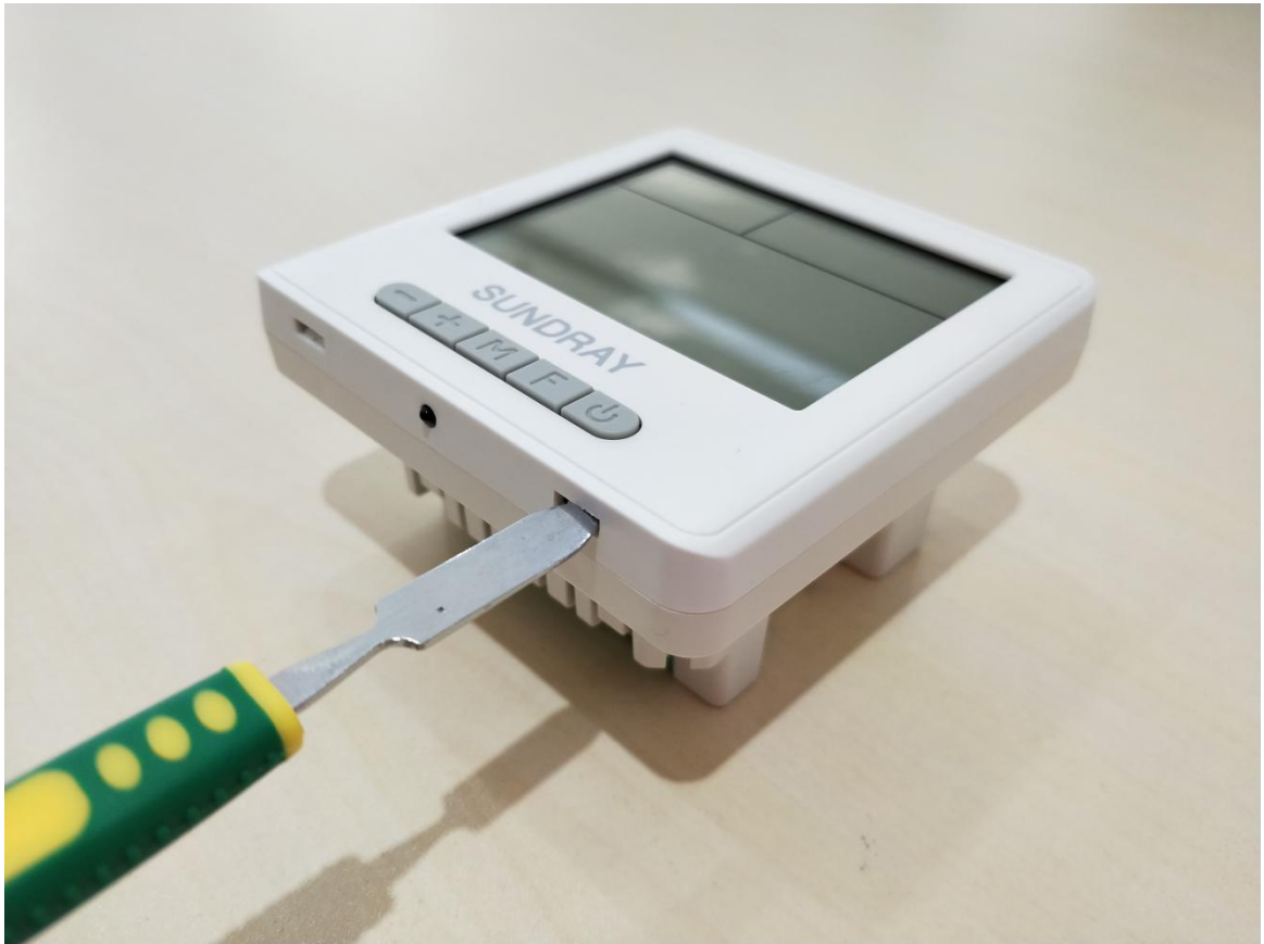
拆开主控板：用 3.5mm 宽的一字改锥沿如图所示位置翘起，打开卡扣
