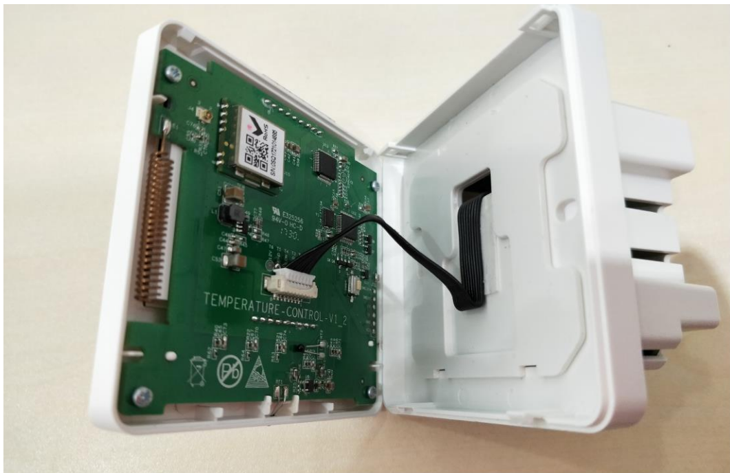
安装螺丝不方便可以取下排线
