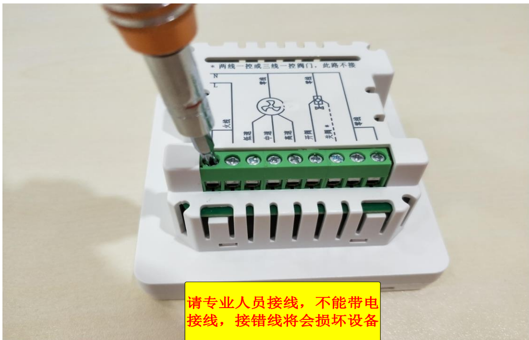
按接线图正确接线，拧紧螺丝
