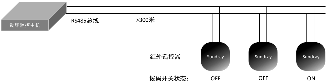
图 0-12 RS485 匹配电阻开关使用示意图
